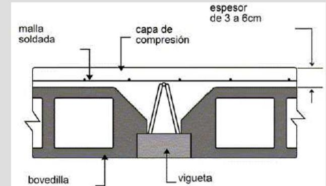
El sistema de losa de Vigüeta y Bovedilla es compuesto básicamente estos dos elementos prefabricados, este sistema es ideal para ser utilizado en viviendas de interés social, residencial, comercial, escolar, etc...
